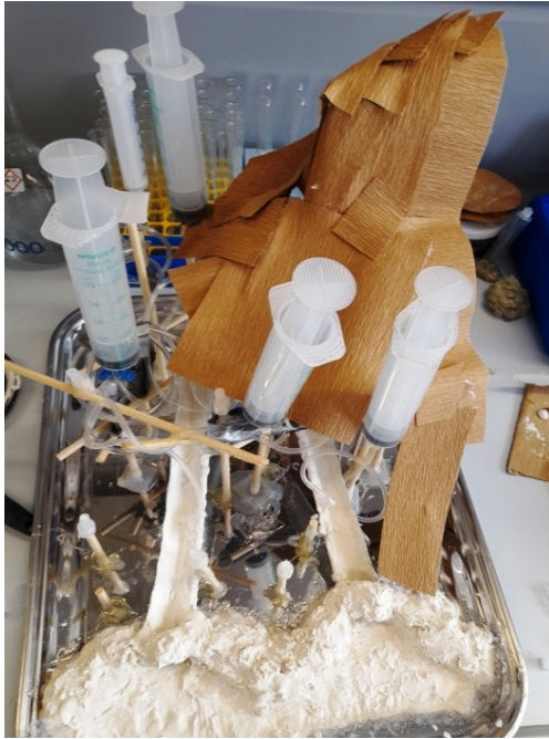
Abbildung 70: Links: Reliefgestaltung mittels Krepp; Rechts: Detaillierter Blick auf die Befestigung der Schwinden sowie Wegleitung des vertikalen Abflusses – dabei basieren vorhandene Schlauchschlingen auf technischer Notwendigkeit, um Schlauchlänge zu verbrauchen und haben keinen Modellierungszweck (eigene Aufnahme, Mai-Juni 2024).
