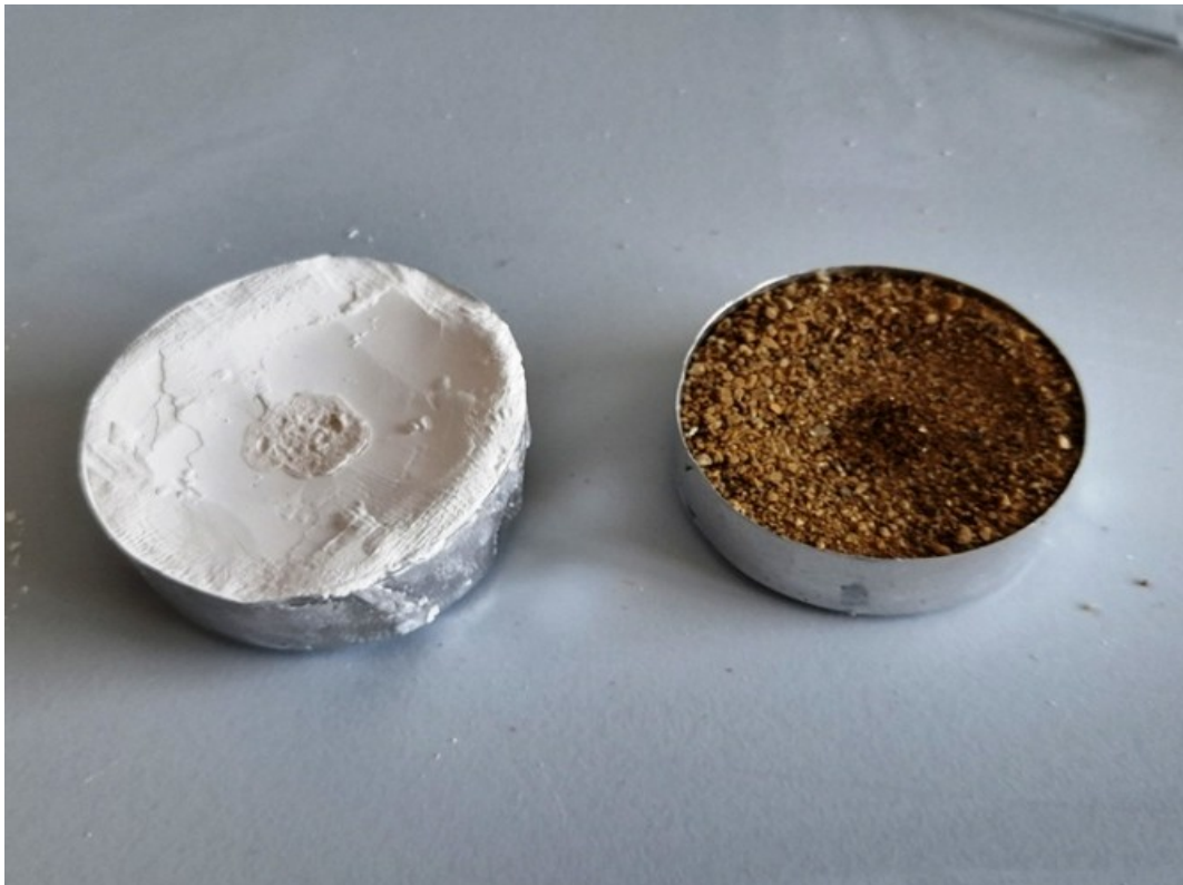
Abbildung 43: Zugabe eines Tropfens Salzsäure; Links: im Kalk zeigt sich ein deutlicher Reaktionsrückstand; Rechts: Sand wird durch die Säure lediglich feucht (eigene Aufnahme, Mai-Juni 2024).
