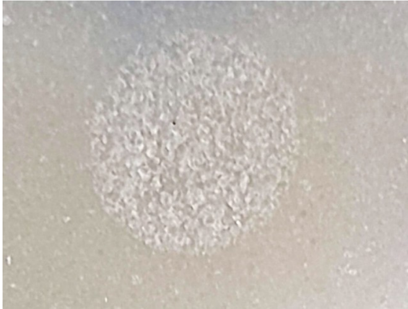
Abbildung 36: Nach Entfernen des Salzsäuretröpfchens ist eine „Beschädigung“ der vormals glatten Marmoroberfläche zu erkennen – wenn man sich nun kein punktuell Einwirken, sondern lineares Abfließen säurehaltiger Medien entlang von Gesteinspaketen aus Calciumcarbonat über einen längeren Zeitraum in Überlegung ruft, lässt sich daraus schließlich auch die Entstehung von Karstrillen imaginieren (eigene Aufnahme, Mai-Juni 2024).
