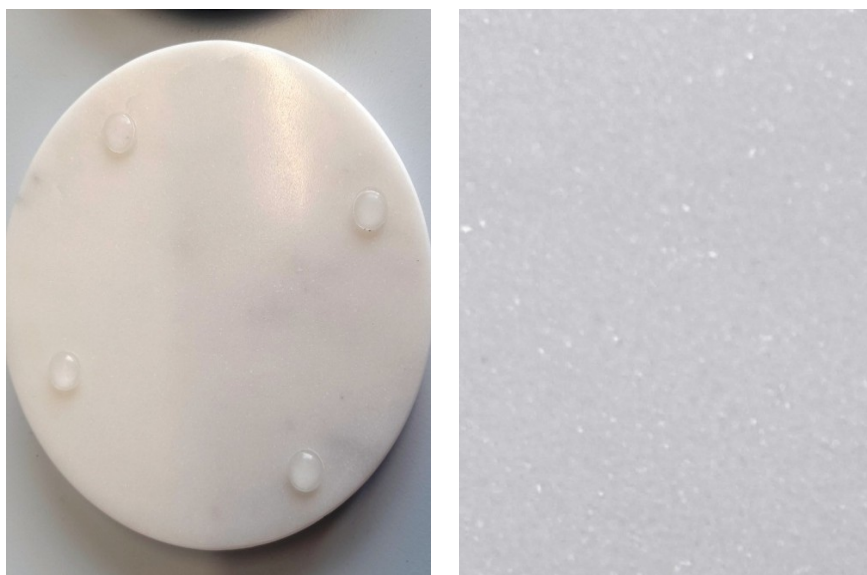
Abbildung 34: Marmorplatte zur Modellierung der Karstrillen-Genese (eigene Aufnahme, Mai-Juni 2024).
