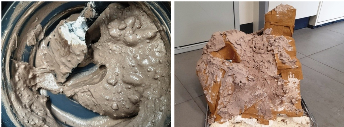
Abbildung 76: Durch Strecken der Sandsteinmodellmasse mit Gips und grobgemörserter Kreide kann eine für Kalkgebirge farblich und texturierte adäquate Oberflächenmasse geschaffen werden (eigene Aufnahme, Mai-Juni 2024).
