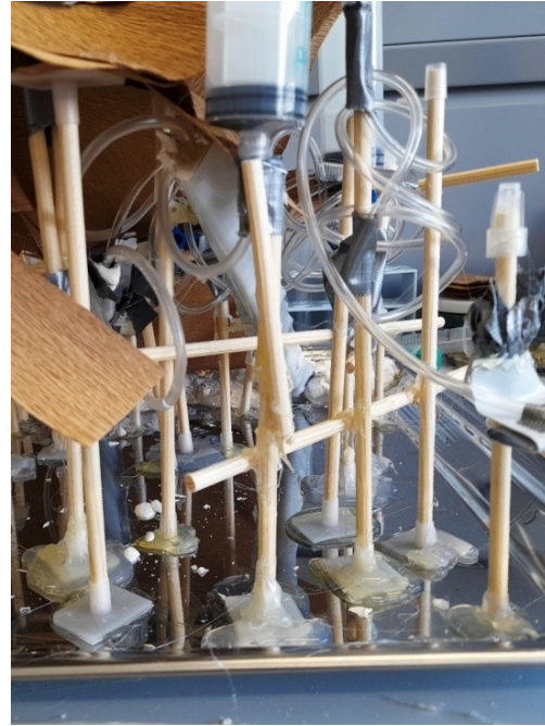
Abbildung 70: Links: Reliefgestaltung mittels Krepp; Rechts: Detaillierter Blick auf die Befestigung der Schwinden sowie Wegleitung des vertikalen Abflusses – dabei basieren vorhandene Schlauchschlingen auf technischer Notwendigkeit, um Schlauchlänge zu verbrauchen und haben keinen Modellierungszweck (eigene Aufnahme, Mai-Juni 2024).
