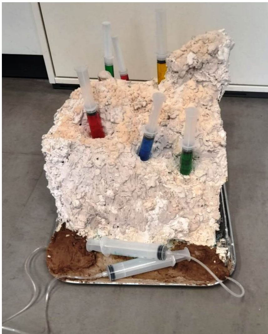
Abbildung 58: Fertiges Bergmodell bereit zur Versuchsdurchführung inkl. Absaugungsvorrichtung – Genese und Erläuterung des Modells inkl. Anleitung siehe Anhang (eigene Aufnahme, September 2024).
