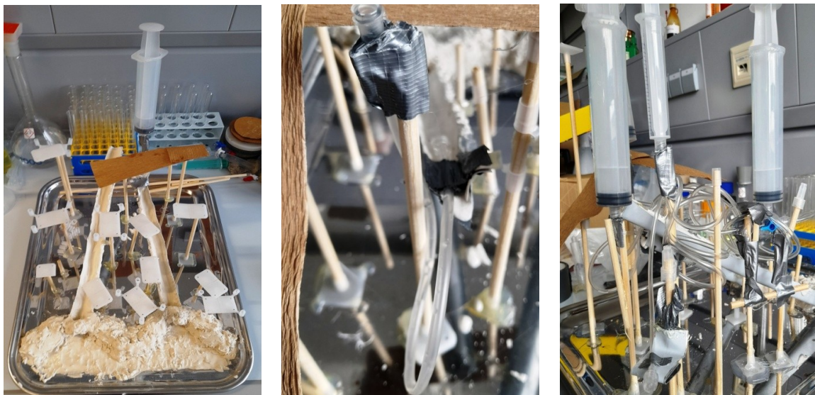
Abbildung 67: Die Modellierung der künftigen Schwinden erfolgt mit Butterflykanülen, sodass die simulierte „Tracerflüssigkeit“ einfach mittels Spritze ins Bergmodell eingebracht werden kann. Zugleich dienen die in weiterer Folge dann unter der Bergmodelloberfläche befindlichen Schlauchteile zur Modellierung des vertikalen unterirdischen Abflusses hindurch wasserdurchlässiges Karstgestein zu den wasserstauenden Schichten, wozu die Schlauchenden an den vergipsten Zinkblechbahnen festgeklebt sind (eigene Aufnahme, Mai-Juni 2024).
