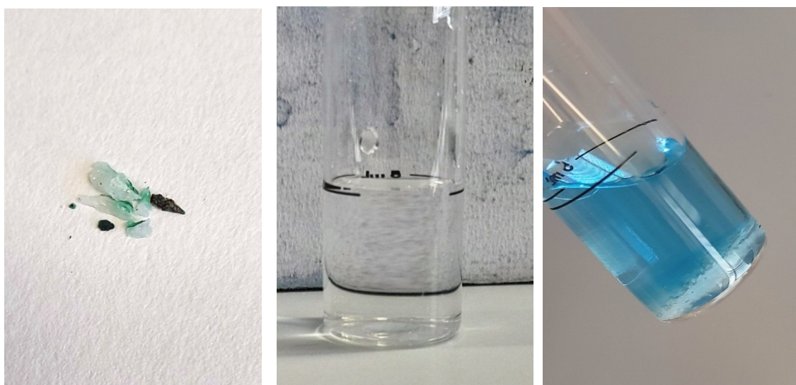
Abbildung 23: Nachweis von Kupferionen in Malachit; Links: Malachit; Mitte: Malachit-Lösung; Rechts: nach Zugabe von Natriumcarbonatlösung (eigene Aufnahme, Mai-Juni 2024).
