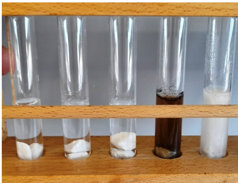
Abbildung 31: Lösungsversuche von Marmor in verschiedenen Medien von links nach rechts: destilliertes Wasser - Kohlensäure warm (ca. 25°C) - Kohlensäure kalt (ca. 10°C) – Huminsäure - Salzsäure (einmolar) (eigene Aufnahme, Mai-Juni 2024).
