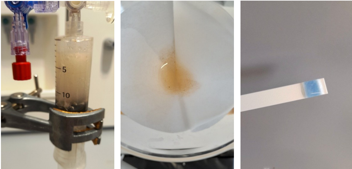
Abbildung 17: Links: Nach Zugabe der Salzsäure in die Probenspritze startet eine starke Reaktion unter Gasentwicklung, die Lösung erhält eine rot/graue Farbe; Mitte: Der Filtrerrückstand ist deutlich rot; Rechts: Das Testfeld des Schnelltests für Eisenionen verfärbt sich blau - näheres zu den Schnelltests findet sich im nachfolgenden Unterkapitel (eigene Aufnahme, Mai-Juni 2024).
