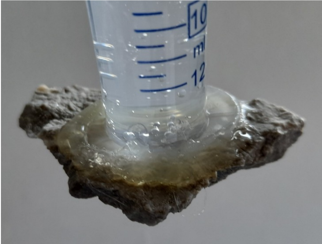
Abbildung 53: Befestigung und Abdichtung Spritzenzylinder/Gesteinsoberfläche mittels Heißkleber (eigene Aufnahme, Mai-Juni 2024).
