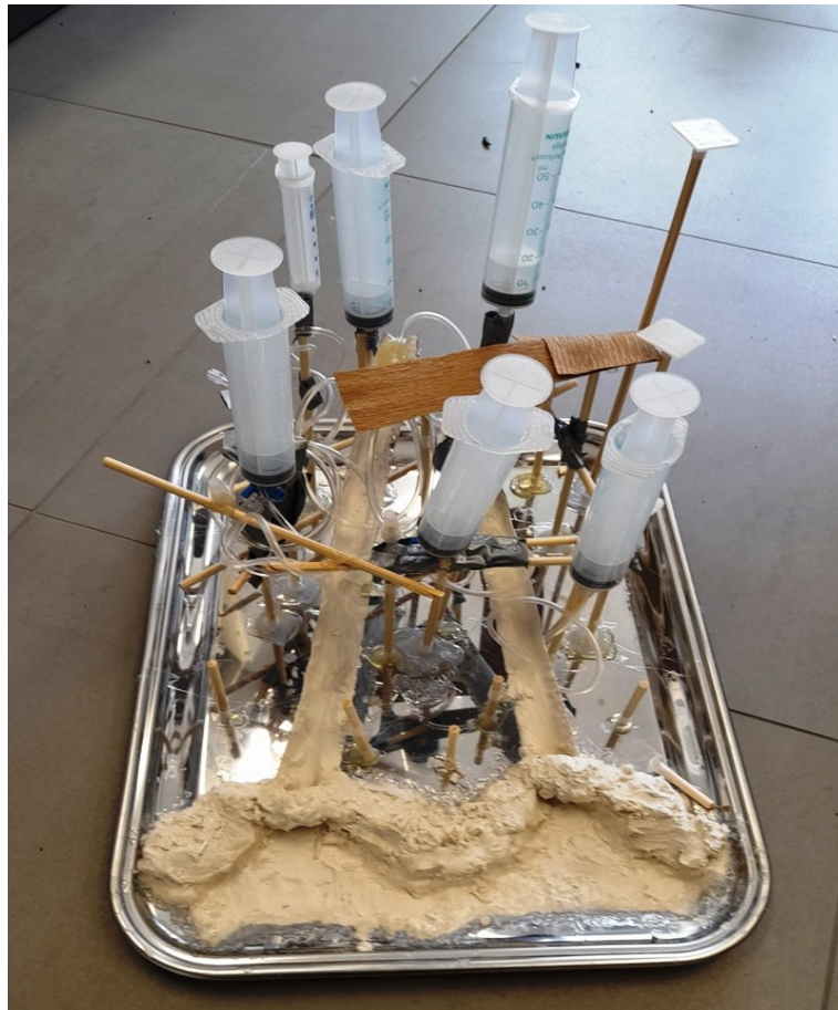
Abbildung 68: Überblicksdarstellung aller Schwinden, mittels Dreiwegeventile ist es möglich, Schwinden mit mehreren Abflusswegen zu modellieren (eigene Aufnahme, Mai-Juni 2024).
