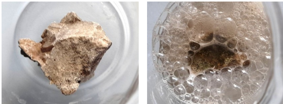
Abbildung 8: Probe Dachsteinkalk; Links: original; Rechts Reaktion unter Zugabe von Salzsäure (eigene Aufnahme, Mai-Juni 2024).
