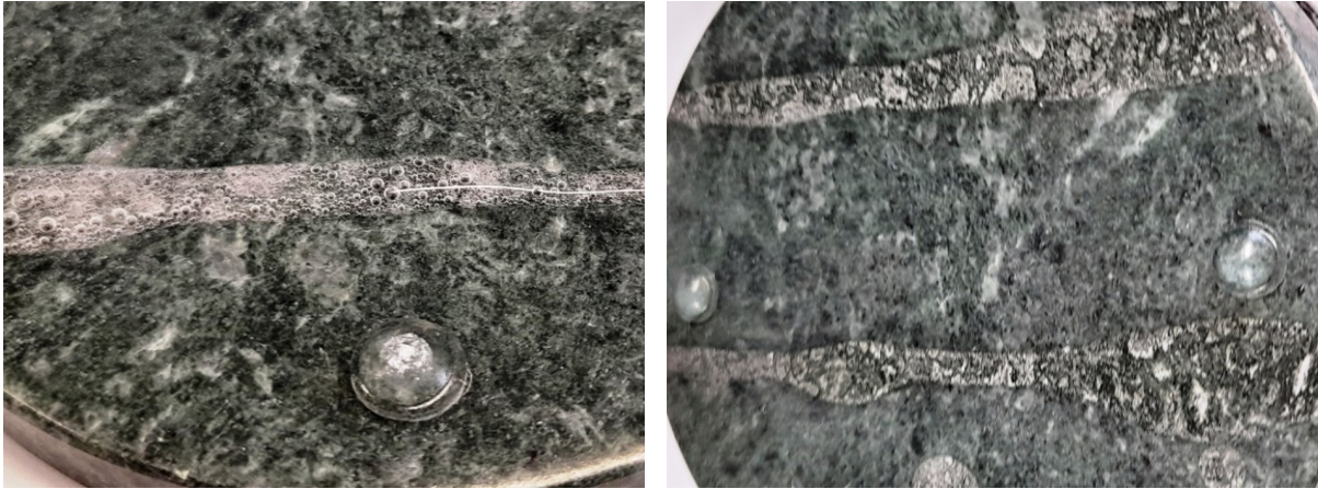
Abbildung 39: Linearer Auftrag von Salzsäure auf die Marmorprobe; Links: ganz deutlich zu sehen die Entwicklung von Gasbläschen durch Reaktion der Säure mit dem Calciumcarbonat; Rechts: lineare Lösungsrückstände nach Entfernung der Säure ermöglichen ein Verständnis zur Genese von Karstrillen (eigene Aufnahme, Mai-Juni 2024).
