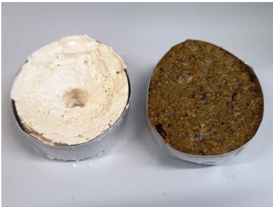
Abbildung 46: Vergleich der Kalk- bzw. Sandprobe nach Versuchsdurchführung: Während die Salzsäure im Kalkuntergrund eine deutliche Trichterform hinterlassen hat inkl. eines stark ausgeprägten Schluckloches, ist beim Sanduntergrund nichts dergleichen festzustellen (eigene Aufnahme, Mai-Juni 2024).
