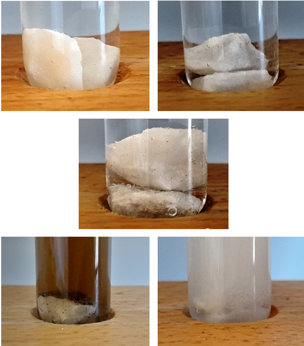
Abbildung 32: Gut zu erkennen ist die unterschiedlich starke Gasentwicklung je nach Lösungsumgebung – am stärksten ist diese in der Salzsäure rechts unten, ebenso noch deutlich zu erkennen in kalter Kohlensäure in der Mitte (eigene Aufnahme, Mai-Juni 2024).
