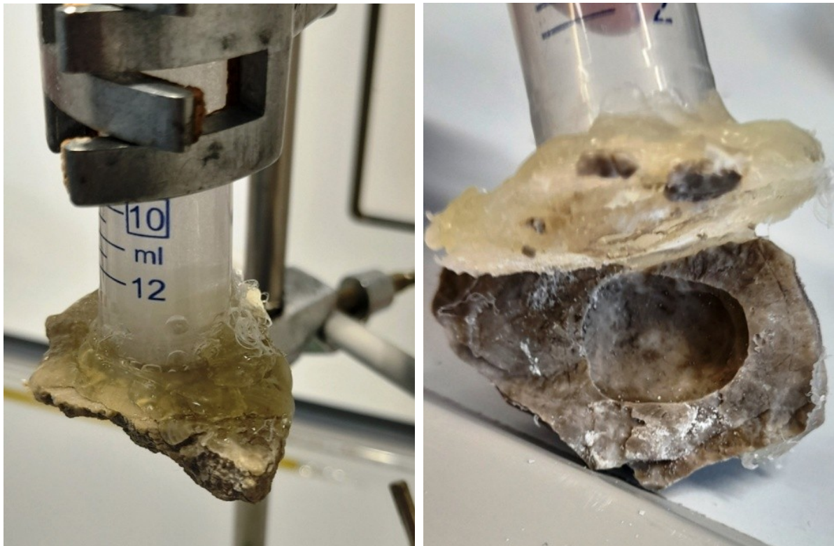
Abbildung 56: Links: Starke Reaktion unter Gasbildung bei Verwendung von Salzsäure, ein Durchsickern ist aber dennoch nicht erreicht worden, allerdings ist nach Entfernung des Aufsatzes eine deutliche Hohlform zu erkennen, die die Säure (rechts) ausgelöst hat (eigene Darstellung, Mai-Juni 2024).
