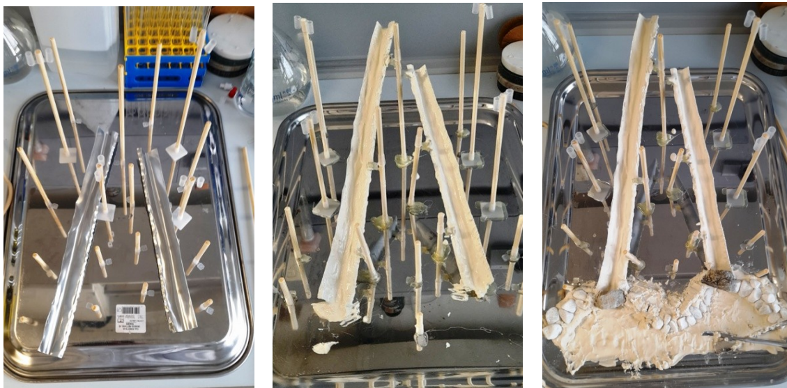
Abbildung 65: Die Ausgangssituation für das Bergmodell: Tablett als Unterlage, zwei Rinnen aus Zinkblech geformt und mittels Gipsoberfläche versehen zur künftigen Modellierung wasserundurchlässiger Schichten sowie Holzstreben als Basis für das künftige Relief – mittels Marmorstein und Gips können Karstquellen modelliert werden und zugleich aus praktischen Gründen als Auffangbecken gestaltet werden (eigene Aufnahme, Mai-Juni 2024).
