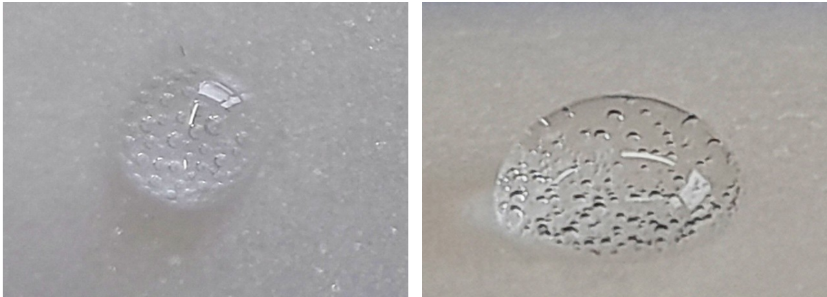
Abbildung 35: Gasentwicklung nach Zugabe einmolarer Salzsäure – Säure reagiert mit Calciumcarbonat unter Freisetzung von Kohlenstoffdioxid. Das ist in Form der Gasbläschen erkennbar (eigene Aufnahme, Mai-Juni 2024).
