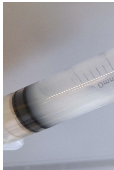
Abbildung 16: Links: Calciumhydroxidlösung; Mitte: Calciumhydroxidlösung, nachdem mittels Spritze das entstandene Gas in die das Reagenzglas eingebracht und geschwenkt worden ist; Rechts: Einwegspritze mit Calciumhydroxidlösung, die an der Apparatur angebracht worden ist und Reaktionsgas aufgenommen hat (eigene Aufnahme, Mai-Juni 2024).
