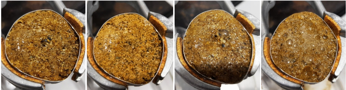
Abbildung 44: Im Gegensatz zum Kalkuntergrund bildet sich bei selber Versuchsdurchführung im Sand keine Trichterform aus – der Boden quillt ob der Flüssigkeit lediglich auf (eigene Aufnahme, Mai-Juni 2024).
