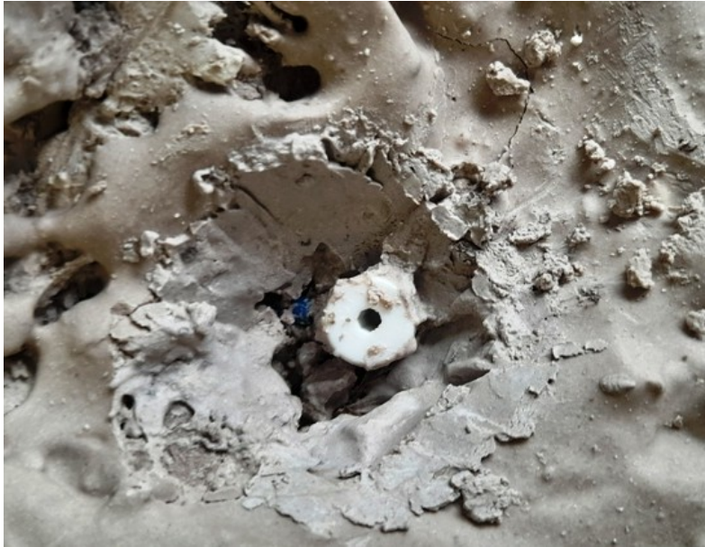
Abbildung 77: Oberflächengestaltung im Bereich einer Schwinde – um einen Verschluss der Butterflykanüle durch die Modelliermasse zu verhindern, erfolgte deren Schutz mittels Schraubverschluss (eigene Aufnahme, Mai-Juni 2024).
